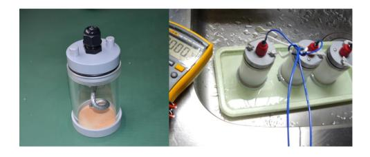
金属電極部 : 鉛電極  $6.0~\mathrm{mm}~\phi$
